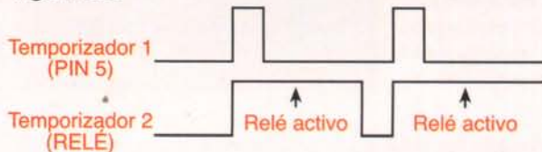
Figura 12.3. Diagrama de tiempos del intervalómetro
